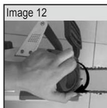
> La chaîne est suffisamment tendue quand elle peut être décollée de 2 à 4 mm au milieu du guide-chaîne. Faites ce test en soulevant la chaîne d'une main sans immobiliser la tronçonneuse.
