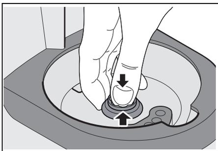
1. Appuyez sur le cache en silicone **36** avec le pouce et glissez simultanément le doigt sous le bord de l'ancien logement du couteau **10**. Sortez l'ancien logement du couteau **10** vers le haut. Il peut éventuellement être nécessaire d'effectuer quelques « à-coups » pour pouvoir retirer le logement du couteau **10**.
